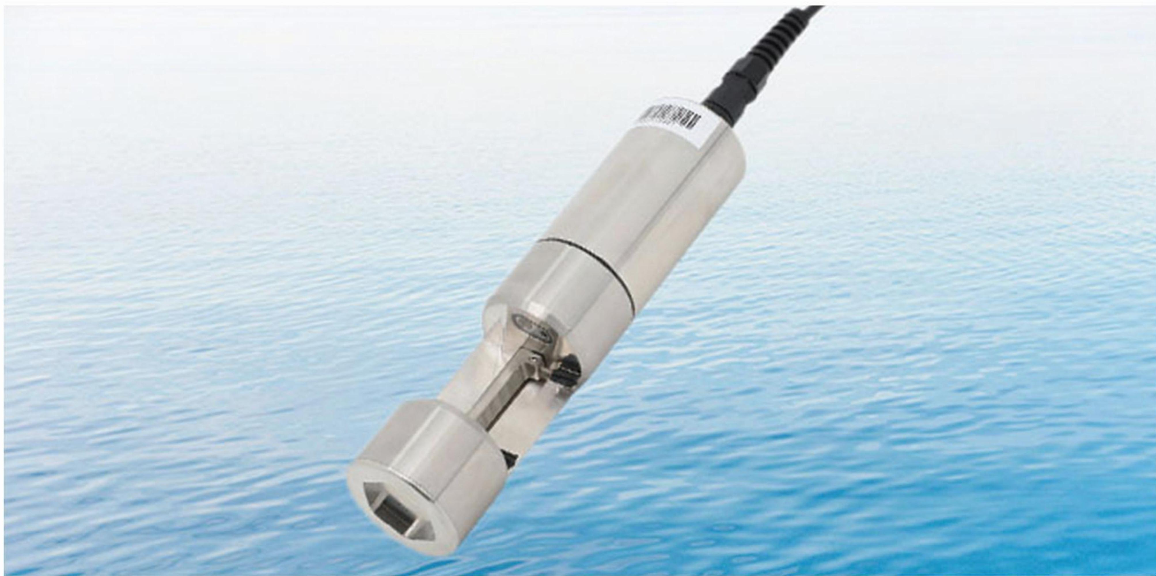
禹山全新透明度传感器采用透射光法测定原理，定制光学器件，尺寸小巧，安装维护简便，无需试剂、无污染、更经济环保。带有自动清洁刷，可消除气泡、减少沾污对测量的影响，使维护周期更长，长期在线使用也能保持极佳的稳定性。
