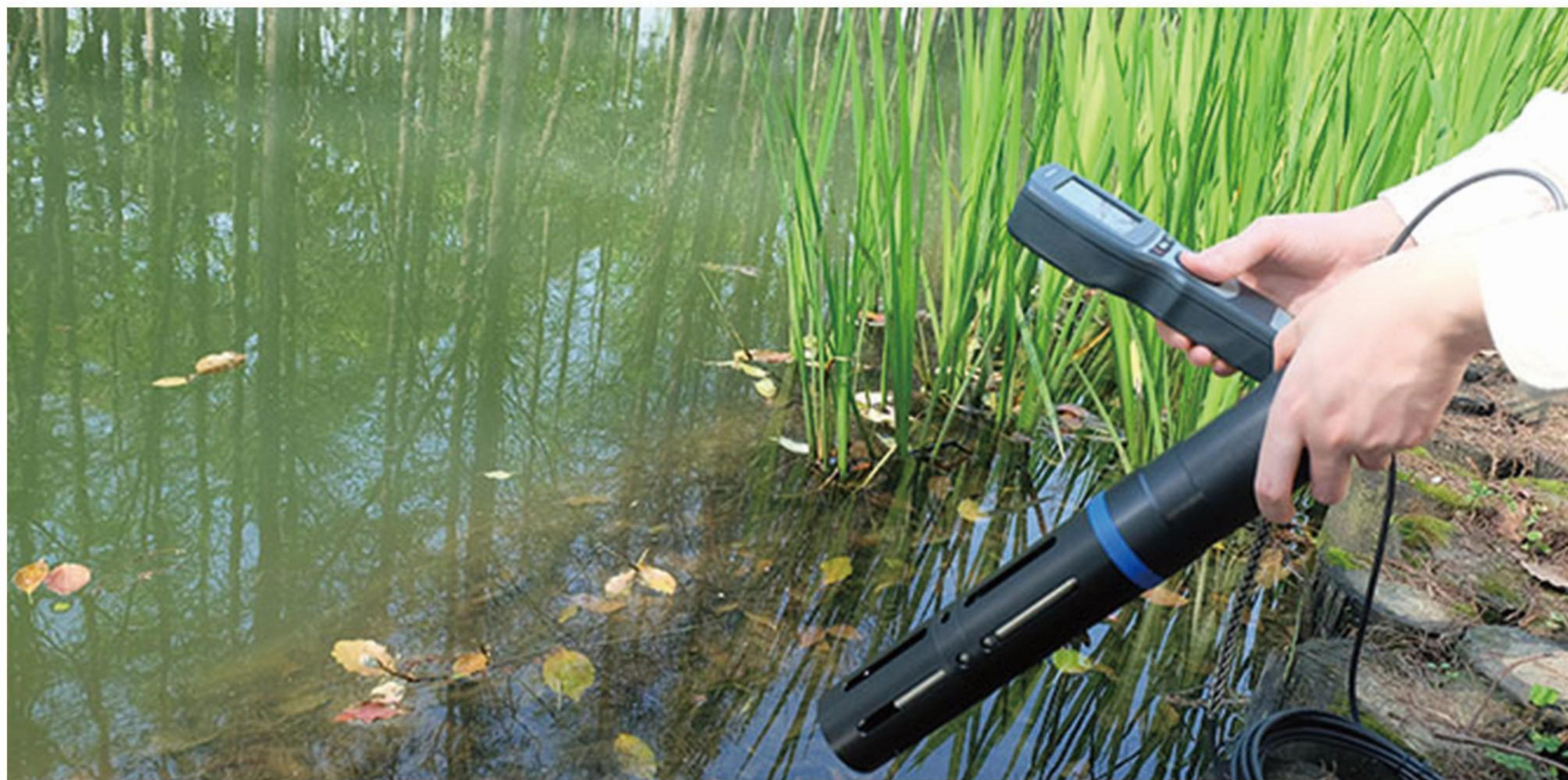
禹山Y4001和Y600-A由禹山传感自主研发。该组合能测量温度、光学溶解氧、光纤式浊度、四电极电导率、pH、盐度等。Y4001 多参数手持探头最多能支持 4 种探头的测量，当连接到Y600-A 仪表，这些数据能被自动识别。本仪表带背光显示和操作键盘，功能全面操作简单，界面简洁，还能够同时实现测量数据的存储，传感器校准等功能，并且可以 USB 数据导出，实现更多高端功能。追求高性价比是我们一贯的追求。
