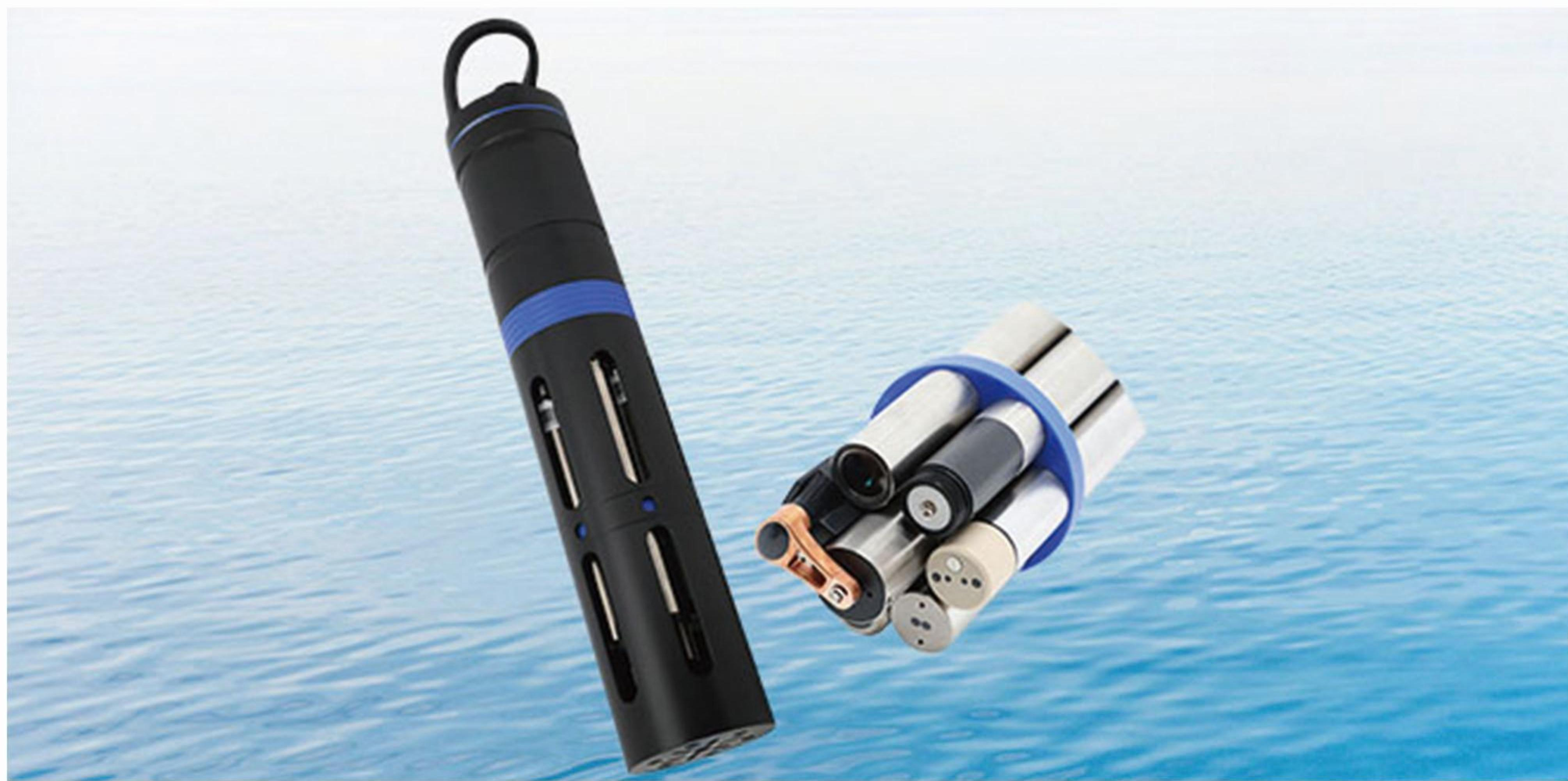
禹山Y4000多参数水质传感器采用多合一结构设计，每支传感器带有防水连接器，校准数据存储在传感器内，可现场校准和替换。除荧光法溶解氧、四电极电导率、光纤式浊度及数字pH常规传感器以外，还可以选择数字ORP、盐度、叶绿素、蓝绿藻及水中油传感器等，最多支持一个多参数母体连接6个数字传感器。
